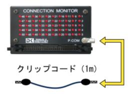
クリップコードを接続されたケー ブルの電線や端子に触れると、対 応したピンのLEDが点灯し、接続を 確認できます
